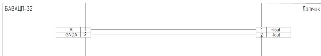
Схема подключения активных датчиков 0–20 мА/4–20 мА
