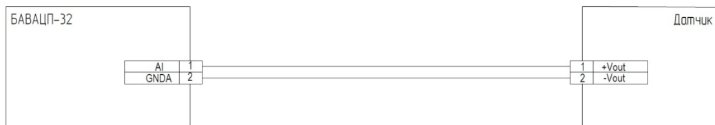
Схема подключения активных датчиков 0–5В, 1–5В, 0–10В
